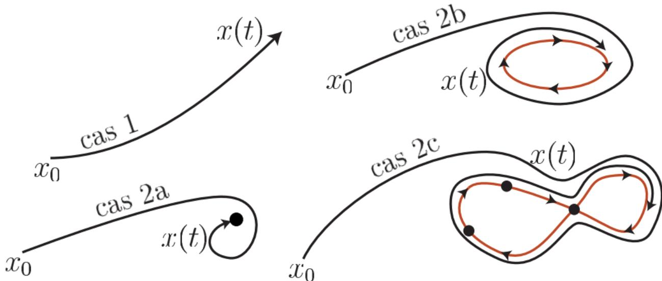
La **divergence**  $\frac{\partial f}{\partial x} - K_p \frac{\partial f}{\partial u} (S^{at})' + K_s ((S^{at})' - 1)$  est **négative** et on a un **seul point** d'équilibre : reste uniquement le cas 2a.
