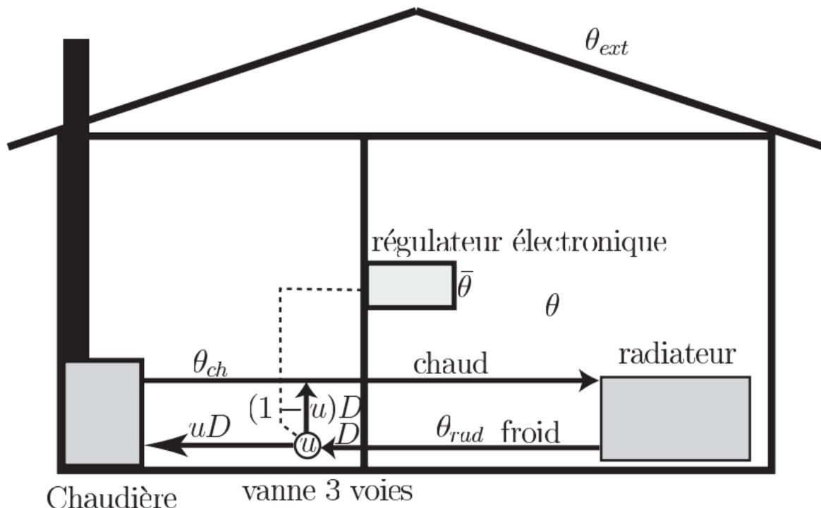
Régulateur **proportionnel intégral (PI)** de la **température**  $y = \theta$  à sa **consigne**  $v = \bar{\theta}$  avec une vanne  $u \in [0, 1]$ , le **contrôle**.
