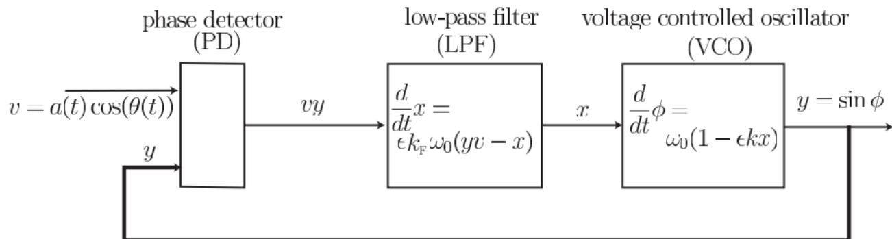
La quantité  $\omega_0(1 - \epsilon kx)$  est une estimation filtrée de la fréquence  $\frac{d}{dt}\theta$  du signal d'entrée  $v$  qui peut être très fortement bruité et dont l'amplitude  $a$  n'est pas connue.
