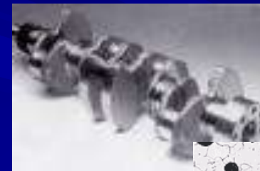
Fatigue des FGS (défauts de surface)
