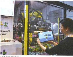
Une application en réalité virtuelle augmentée renseigne sur une tablette les éléments clés de la ligne, les valeurs réelles et prédites des indicateurs et, si nécessaire la fiche de maintenance de l'outil robotique.
