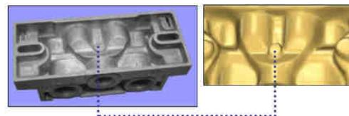
Le capteur Sweep 3D conçu par Algoss est basé sur un système breveté permettant de scanner en 3D la forme d'un objet.
